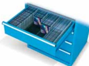
■ In der Schublade mit 175 mm h können (mit 4 Gitterrosten ART. NR. C MV 99 126) 120 CD- oder DVD-Standardhüllen (142x10x125 mm) aufbewahrt werden. Die Hüllen können mit **nach oben gerichteten Rücken aufbewahrt werden**. Der Gitterrost wird mit Länge 36 Eh (600 mm) geliefert. Damit er in diese Schublade eingebaut werden kann, muss er um 9 Eh (153 mm) gekürzt werden.
