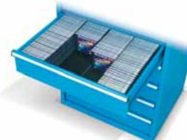
■ In der Schublade mit 150 mm h können (mit 4 Gitterrosten ART. NR. C MV 99 126) 120 CD- oder DVD-Standardhüllen (142x10x125 mm) aufbewahrt werden. Die Hüllen können mit **seitlich gerichtetem Rücken aufbewahrt werden**. Der Gitterrost wird mit Länge 36 Eh (600 mm) geliefert. Damit er in diese Schublade eingebaut werden kann, muss er um 9 Eh (153 mm) gekürzt werden.
