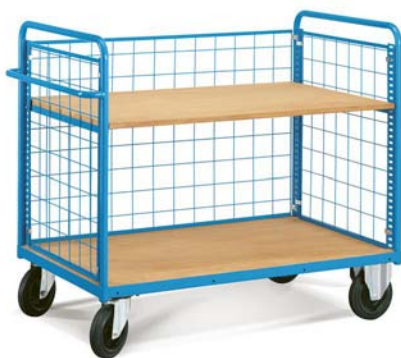
ART. NR. Abm. mm F CI P256 06 04 1425x825x1200 H Wagen mit 2 Lenkrollen mit Feststeller und 2 Bockrollen Ø 200 mm aus Standardgummi
