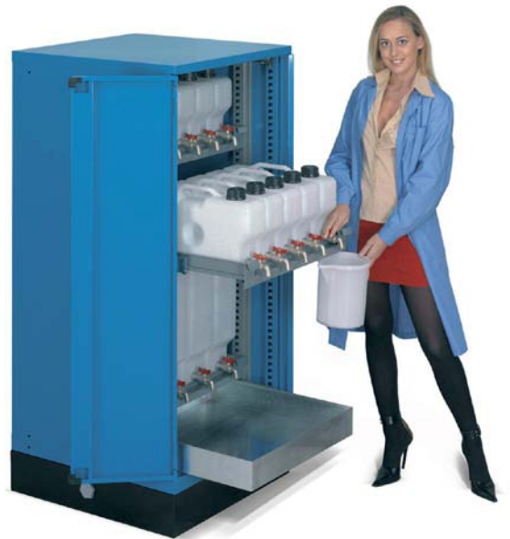
ART. NR. F AE 8058 42 04 Abm. mm 717x750x1600 H. Beispiel bestehend aus: 1 Schrank mit: 3 Teleskopvollauszugböden (200 kg), 4 Plastikkanistern Fassungsvermögen 25 l, 10 Plastikkanistern Fassungsvermögen 10 l, 1 ausziehbare Ölsicherheitswanne Fassungsvermögen 40 l, 1 Ölsicherheitswanne Fassungsverm. 77 l, 2 Stopfen für Wanne.
