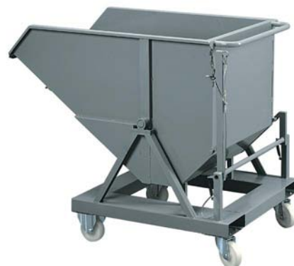
ART. NR. Abm. mm F ML 0200 10 01 965x1480x1265 H Kippbehälter mit 2 Lenkrollen ohne Feststeller Ø 160 mm und 2 Bockrollen aus Nylon Ø 160 mm. TRAGKRAFT KG: 900.
